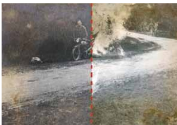
Fot. 4. Fragmenty fotografii wykonanej w technice żelatynowo-srebrowej, z widoczną degradacją warstwy obrazu, przed (lewa strona) i po (prawa strona) 24-godzinnej symulacji zalania. Widoczna miejscowo rozpuszczona warstwa obrazu (fot. A. Seweryn)
