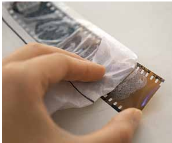
Fot. 1. Próba usunięcia koszulki wykonanej z glassine paper (pelur) z zalanego i wysuszonego negatywu (fot. A. Seweryn)
