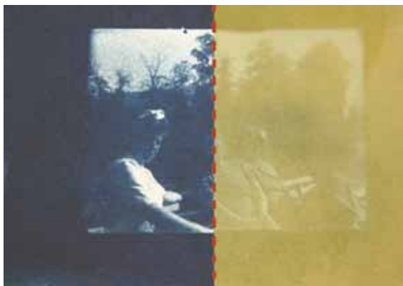
Fot. 2. Fragmenty fotografii wykonanej w technice cyjanotypii przed (lewa strona) i po (prawa strona) 24-godzinnej symulacji zalania. Widoczna utrata pierwotnej barwy obrazu (fot. A. Seweryn)
