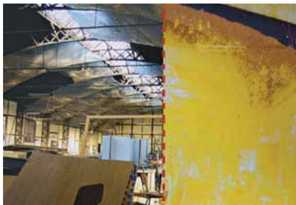
Fot. 5. Fragmenty fotografii barwnej przed (lewa strona) i po (prawa strona) 72-godzinnej symulacji zalania. Widoczna degradacja ujawniająca fragmenty składowych warstw obrazu: cyan, magenta i yellow (fot. A. Seweryn)
