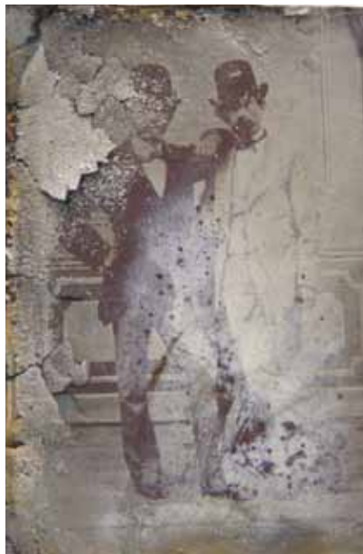
Fot. 11. Ferrotypia po 24-godzinnej symulacji zalania oraz po procesie mrożenia. Widoczna miejscowa utrata obrazu fotograficznego oraz miejscowe odspojenie się warstwy obrazu od podłoża (fot. A. Seweryn)
