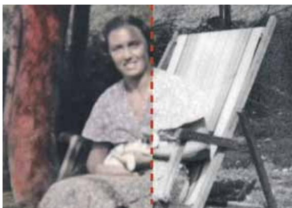
Fot. 3. Fragmenty kolorowanej fotografii wykonanej w technice żelatynowo-srebrowej przed (lewa strona) i po (prawa strona) 24-godzinnej symulacji zalania. Widoczna utrata retuszu wykonanego akwarelą (fot. A. Seweryn)
